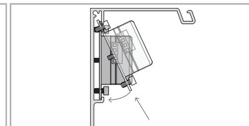
02. Coloque a chapa na porta, encaixando primeiramente o topo e de seguida, o limite inferior da chapa.
