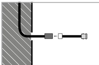
**03.** Passe o cabo de cada fotocélula pelo interior do pilar ou chapa de alumínio, até chegar ao módulo presente no cofre.
